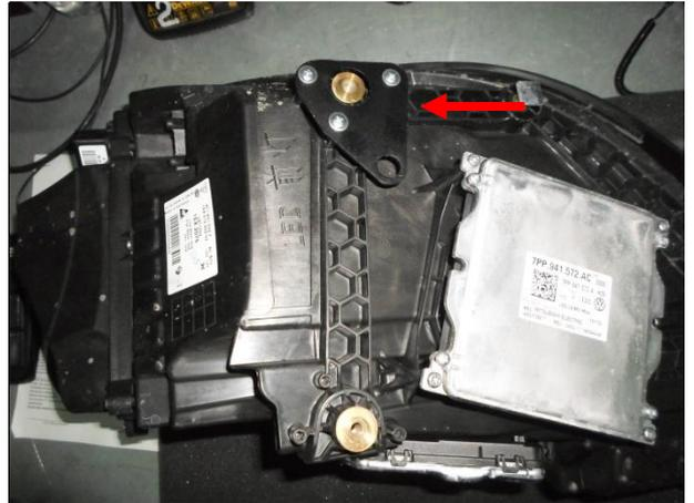
Установить дополнительные флажки прикрутив их саморезами из комплектации.
