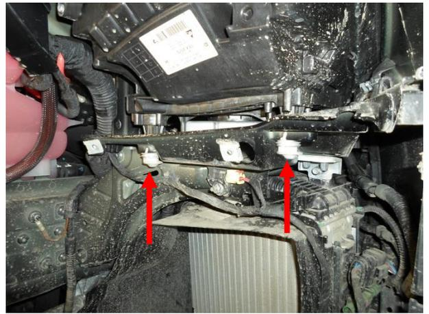
Вывернуть болты, отсоединить фишки, снять фару.
