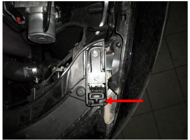
Завести замок под шляпку болта. Притянуть замок срывными болтами М6х20 и М6х25.
